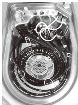
図 4 洗浄・消毒装置への スコープのセット
